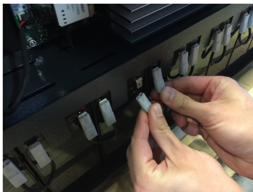
Рисунок 6 – Электрическое соединение батарей с помощью перемычки
