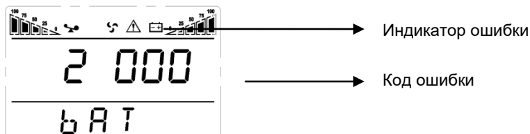
Рисунок 10 – Отображение кода ошибки на экране ИБП
