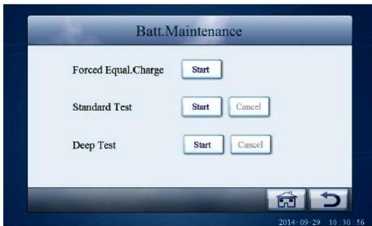
Рис.7-32 Экран обслуживания и проверки батарей
