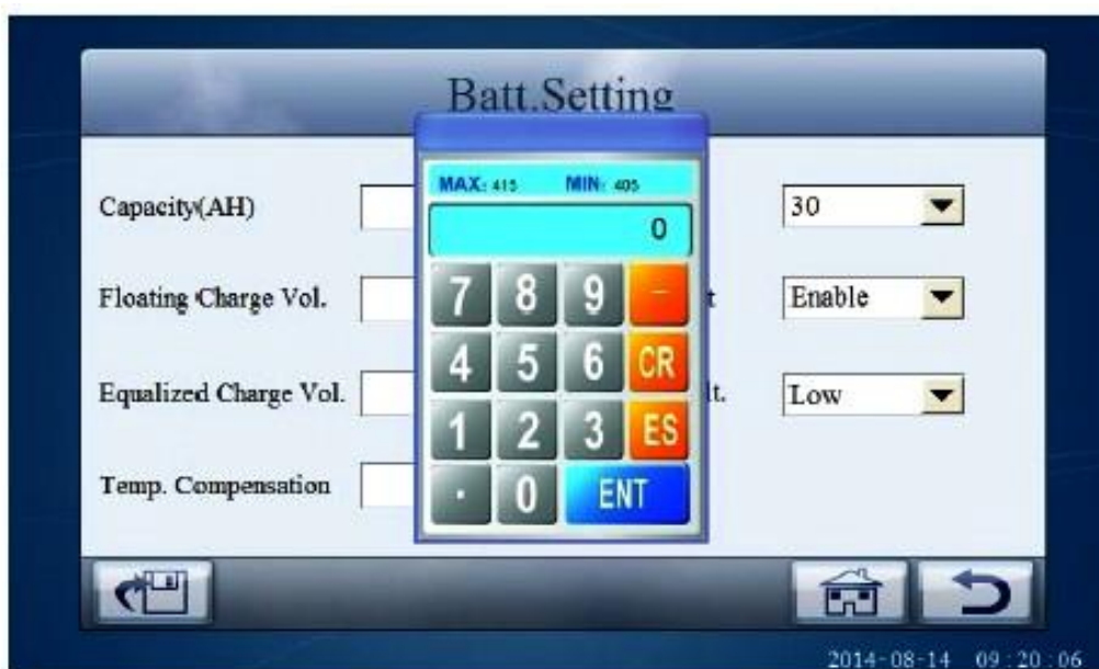
Рис.7-31 Установка параметров «плавающего» заряда
