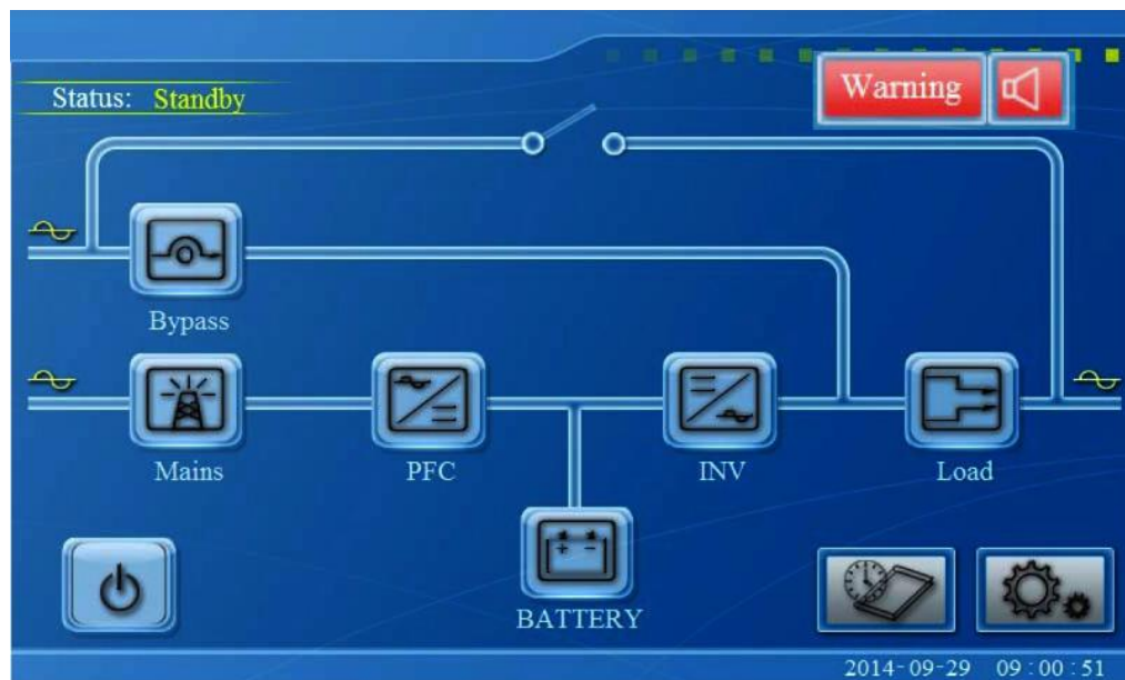
Рис. 7-8 Защита от сбоя / неисправности (ИБП блокирован, нагрузка не поддерживается).
